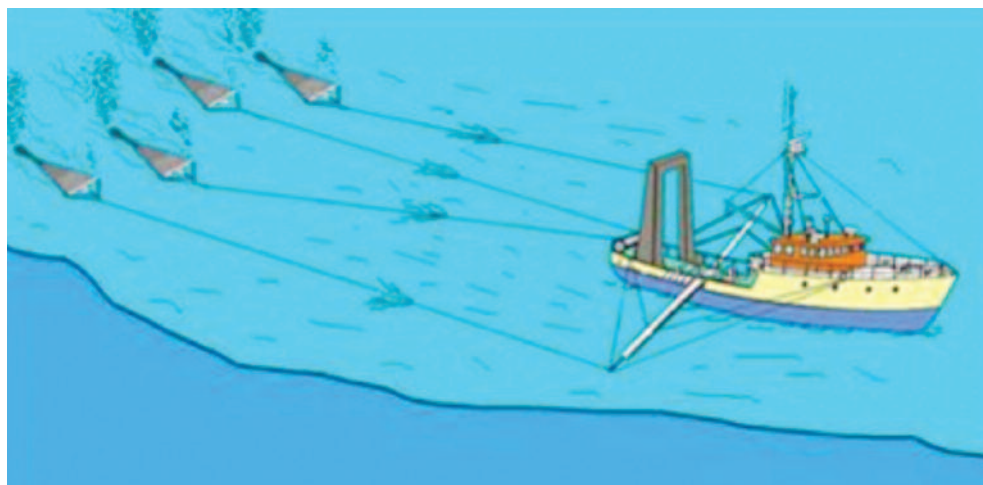
Fig. 3 - Illustrazione di un'imbarcazione operante a rapidi. I "buttafuori" visibili nel disegno consentono di trainare fino a 6 rapidi contemporaneamente.
