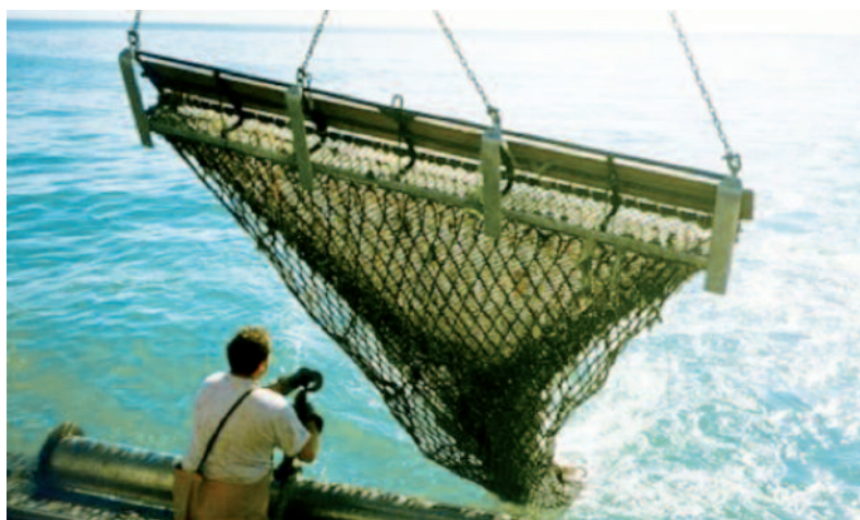
Fig. 1 - Vista di un rapido al momento del salpamento; si può notare la struttura rigida che costituisce l'apertura della bocca stessa, su cui è montata la rete
